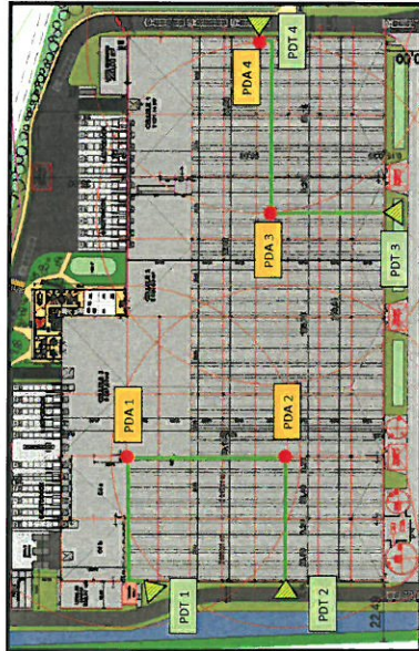
Installation des paratonnerres, conducteurs de descente et prises de terre
